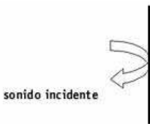
Figura 2. Esquema de incidencia de una onda acústica sobre un cuerpo de elevada densidad.
